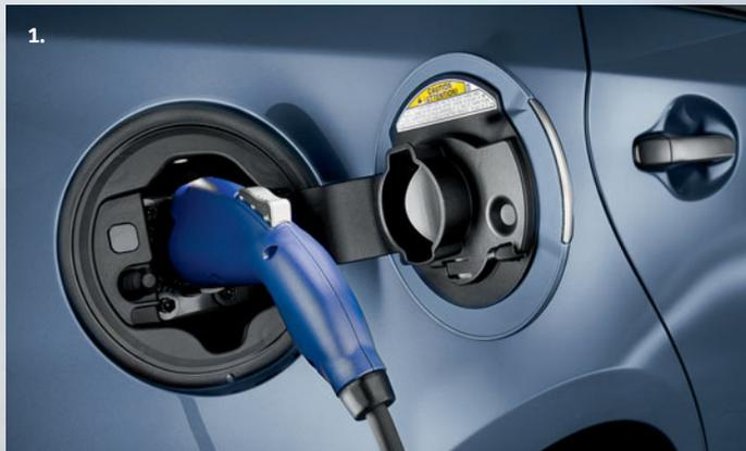
1. La presa di ricarica sulla vettura è dotata di un indicatore dello stato di carica e di un'illuminazione. È facilmente accessibile sopra il parafrangente posteriore sul lato passeggero.
